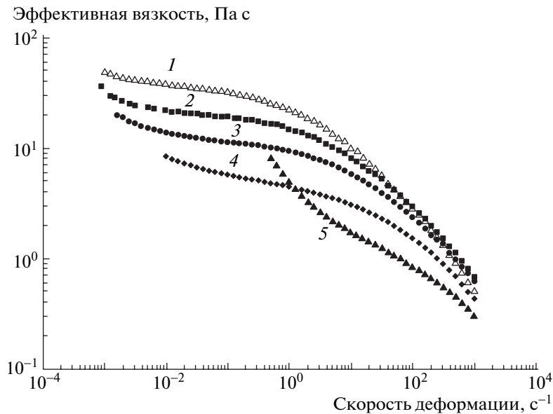
Рис. 4. Зависимости эффективной вязкости раствора хитозана от скорости сдвига при 10 (1), 20 (2), 30 (3), 50 (4) и 70 °C (5). Точки — экспериментальные данные, кривые — расчет.
